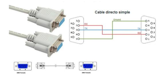
1. Lo primero que haremos es realizar la conexión física de la balanza al equipo utilizando el cable rs232, si el computador no tiene este puerto también llamado puerto serial tendremos que utilizar un convertidor.
