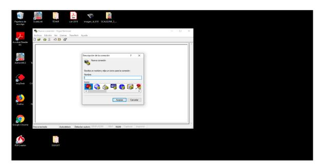
3. En la "Descripción de la conexión" asignamos un nombre a la conexión del HyperTerminal, seleccionamos un icono le daremos Aceptar
